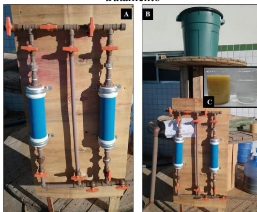
Figura 2: Miniestação de tratamento de água; a) sistema de filtros; b) decantação; c) água antes e depois do tratamento
