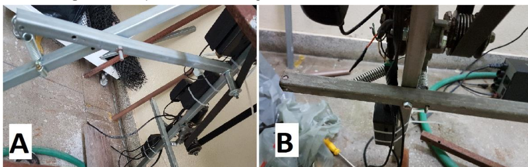
Figura 10: Braço e mola utilizados para tensionamento da correia do motor.
